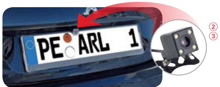
Exemple de fixation de la caméra de recul
